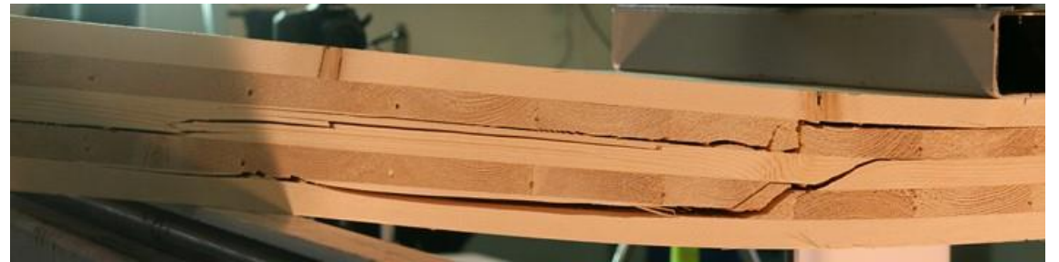
Pituus- ja poikittaissuuntaisten lamellien leikkausmurto
